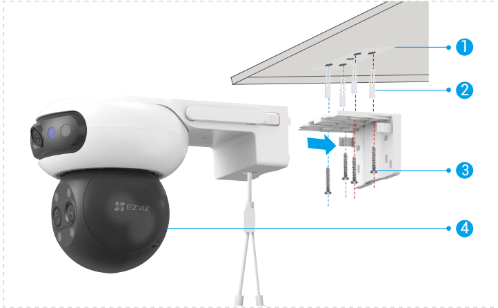
รูปที่ 1 การติดตั้งบนเพดาน
